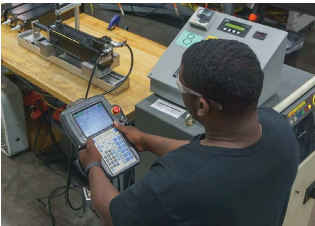
El ensayo final del sistema asegura que el dispositivo de retroalimentación está alineado de forma adecuada con los polos del motor ServoWeld.
